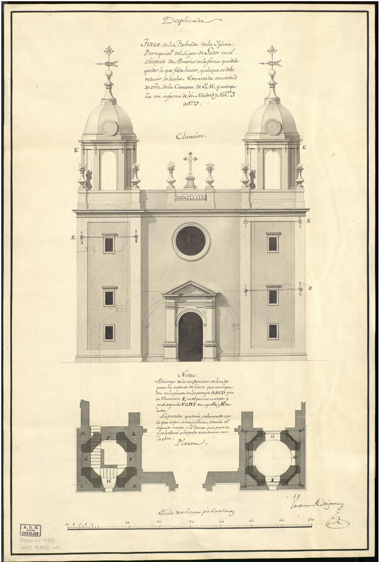
Fig. 67- Ventura Rodríguez: Planta, alzado y sección de la cúpula para la iglesia parroquial de Gádor, 1779. Archivo Histórico Nacional.
